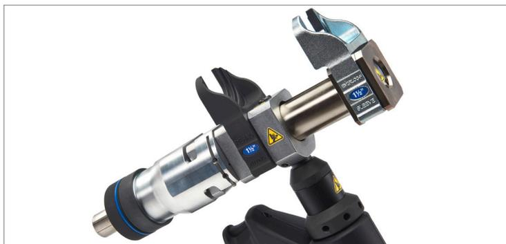
10. Si nécessaire, retirez l'adaptateur d'expansion pour faciliter la compression de l'ensemble du raccord. Appuyez sur le levier de dégagement et faites glisser l'adaptateur pour le retirer de la rainure d'expansion.
