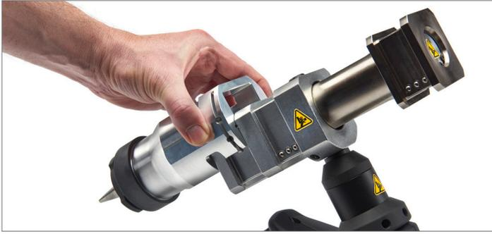
4. Fije el cabezal expansor en su posición. Verifique que el cabezal expansor quede trabado con un clic audible.
