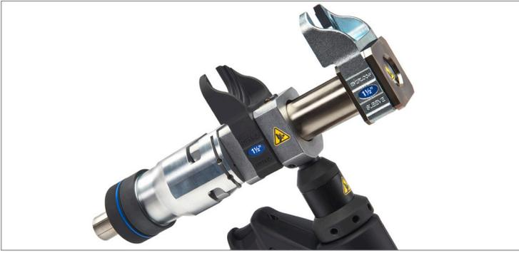
10. De ser necesario, extraiga el adaptador de expansión para simplificar la compresión durante el montaje del accesorio. Presione la palanca de liberación y deslice el adaptador fuera de la ranura de expansión para extraerlo.
