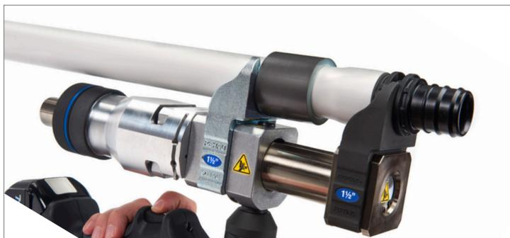
15. Pour relâcher la pression hydraulique et remettre l'outil à sa position initiale, appuyez sur le bouton de déverrouillage.
