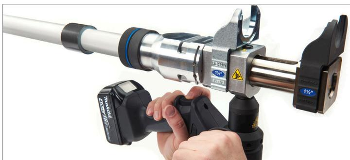
14. Pour comprimer le manchon EVERLOC+, la mâchoire de compression noire doit être placée sur le raccord et la mâchoire argentée doit être placée derrière le manchon. Il peut être nécessaire de contrôler le tuyau pendant l'installation. Veillez à garder vos mains et vos doigts éloignés des pièces en mouvement.
