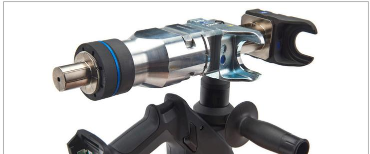
9. Si nécessaire, changez et retournez les mâchoires de compression pour faciliter la compression de l'ensemble du raccord.
