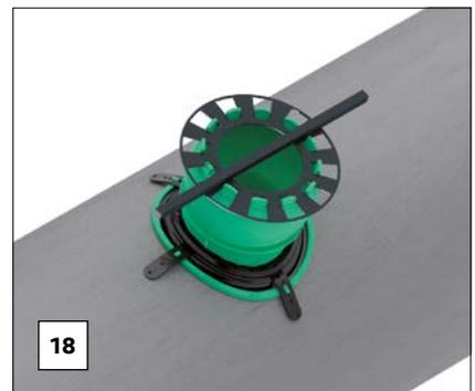
16. Den Montageschlüssel auf die Schraubkrone setzen und einrasten. Die Griffstange des Schlüssels liegt dabei direkt neben den Kronenzacken mit Rastelementen.
