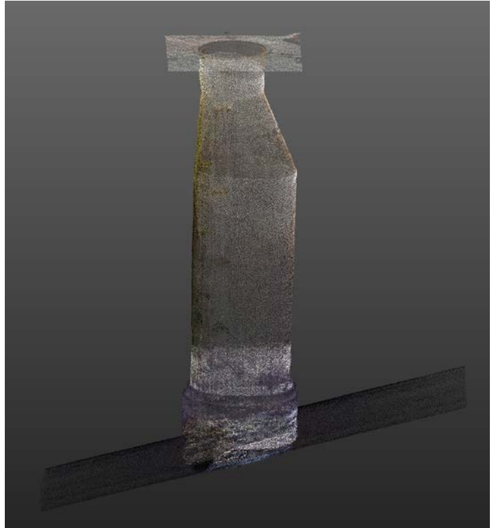
4m длабока основа на шахтата од тули, со бетонски прстени и конус
