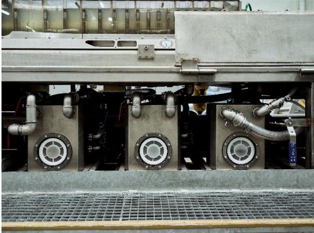
Figure 2 : Pompes Blue Vac pour tables de calibrage
