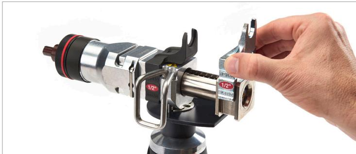
6. De ser necesario, el cabezal de la herramienta se puede girar para facilitar la instalación. El cuello gira con el cabezal de la herramienta. Repare o reemplace un cuello dañado antes de usar.
