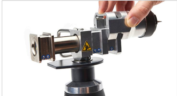
4. Fije el cabezal expensor en su posición. Verifique que el cabezal expensor quede trabado con un clic audible.
