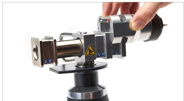
4. Verrouillez la tête d'expansion pour la bloquer en position. Assurez-vous que la tête d'expansion se verrouille avec un déclic audible.
