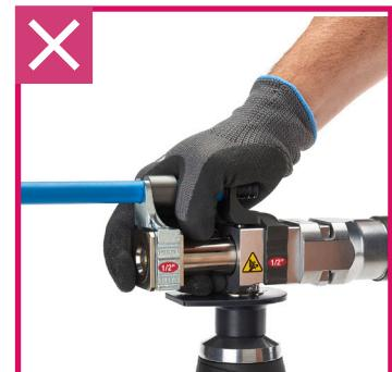
14. Pour relâcher la pression hydraulique et remettre l'outil à sa position initiale, appuyez sur le bouton de déverrouillage.
