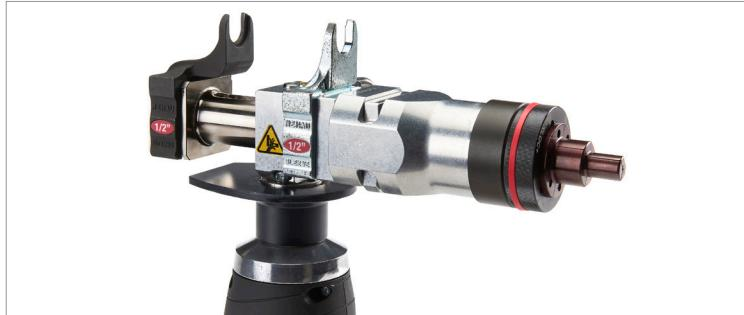
9. De ser necesario, extraiga el adaptador de expansión para simplificar la compresión durante el montaje del accesorio. Presione la palanca de liberación y deslice el adaptador fuera de la ranura de expansión para extraerlo.
