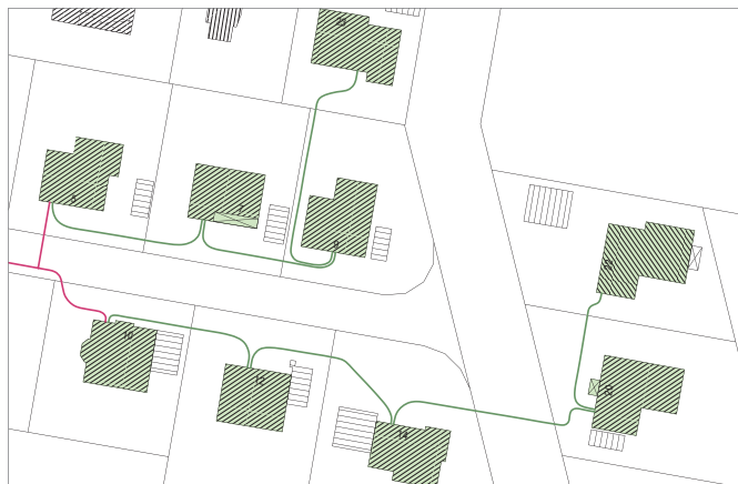
Obr. 6-5 Pokládka trasy „od domu k domu“/jednosmyčková metoda
