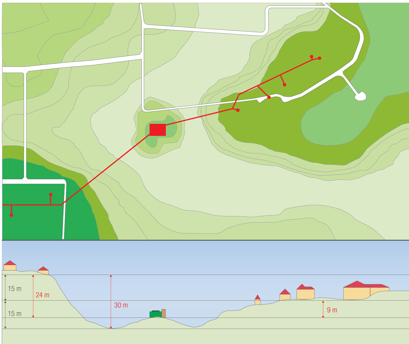
Obr. 6-14 Příklad výškového profilu teplovodní sítě
