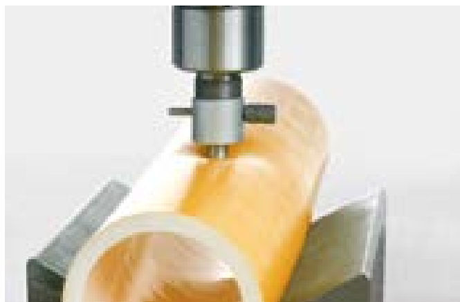
Obr. 3-4 Zkouška bodového zatížení
